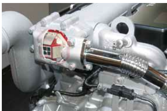
Rückschlagventil am Motor (optisch aufgeschnitten)
